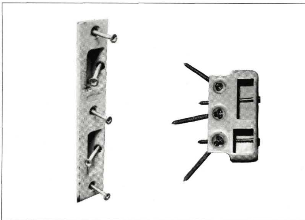
Schuin in de sluitkom en sluitkast aan te brengen schroeven
