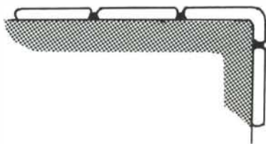
Goede detaillering van tegelwerk op de hoek.
